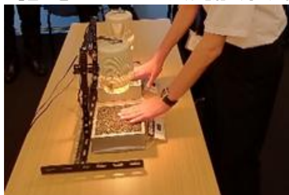
遮熱性舗装と通常の舗装の表面温度を比較
