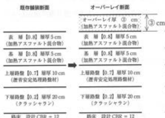
図 2 - 3 オーバーレイ舗装補修断面
