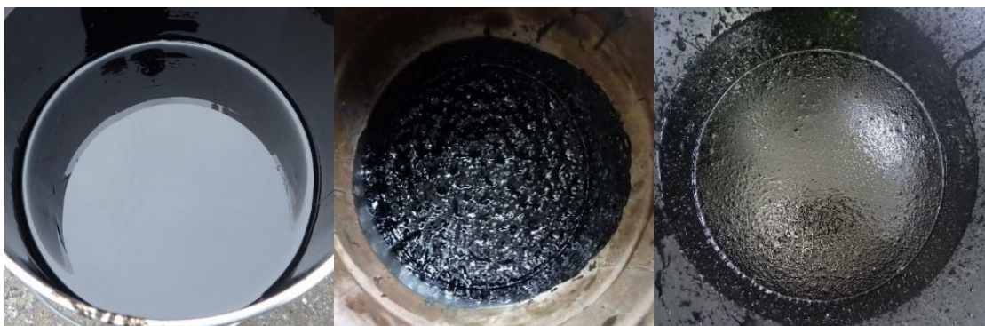
写真-3.2 アスファルトの発泡状況
