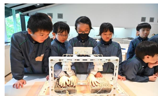
遮熱性舗装と通常の舗装の表面温度を比較
