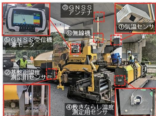
図-4 アスファルトフィニッシャーへの機器の設置状況
