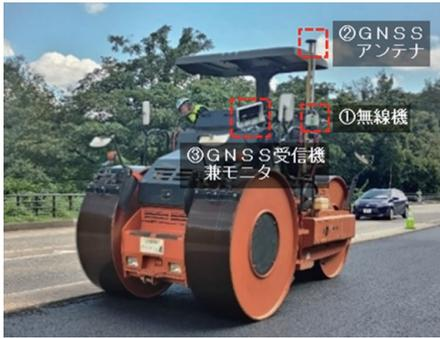
図-6 転圧機械への機器の設置状況
