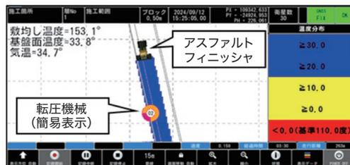
図-5 アスファルトフィニッシャーに設置したモニタの画面
